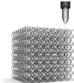
Figure 9- Réalisation de pièces complexes sans soudures ni assemblages
