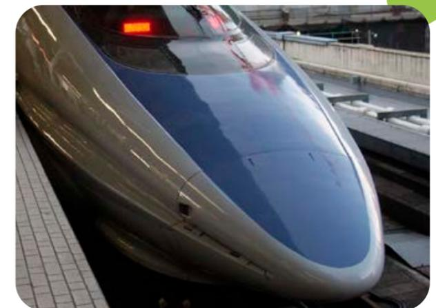
L'avant du train Shinkansen au Japon bio-inspiré du bec du martin pêcheur qui a permis la suppression des bang sonores à la sortie des tunnels et une économie d'énergie de 15%
